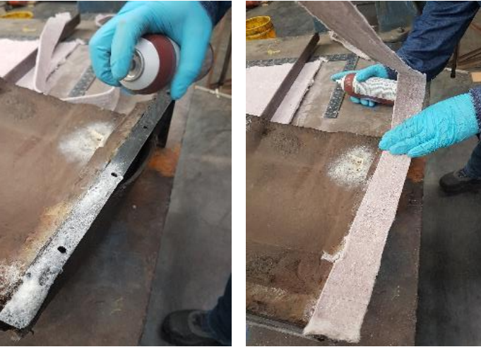
Imagen 10. Empaque de cubierta del motor hacia la cabina.
