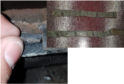
Imagen 4. Empaque de cubierta de protección del motor hacia la cabina.
